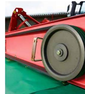
Invirtiendo la polea de transmisión, es posible trabajar a 750 rpm o 1000 rpm.
