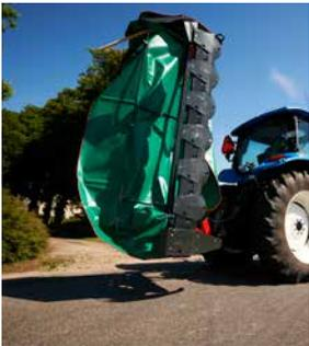
La segadora se pliega vertical e hidráulicamente para su transporte detrás del tractor.
