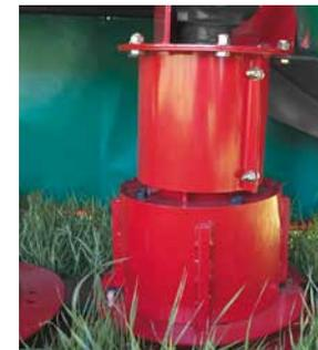
La barra de corte de 10 discos está equipada con un accionamiento directo entre la caja de cambios y la barra de corte, lo que reduce la pérdida de potencia.
