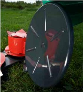
El disco hilerador reduce el ancho de la hilera y, sobre todo, permite limpiar la hierba cortada de la no cortada.
