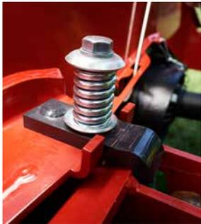
En caso de obstáculo, la unidad de corte está protegida por el dispositivo de seguridad Non-Stop.
