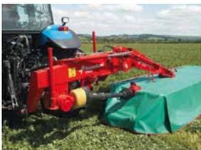
Suspensión hidráulica para un ajuste preciso de la presión del suelo.
