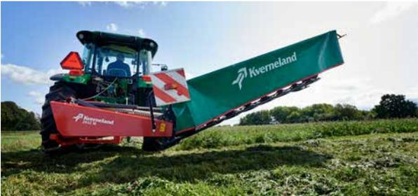
La máquina se levanta en las cabeceras sin tener que hacer ningún ajuste en el elevador de potencia del tractor.
