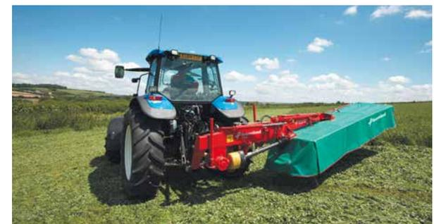
Levante la máquina hidráulicamente sin accionar el elevador de potencia del tractor.
