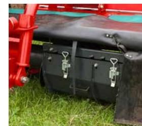
El ancho de la hilera se ajusta fácilmente desbloqueando y moviendo las placas de la hilera hacia los lados.
