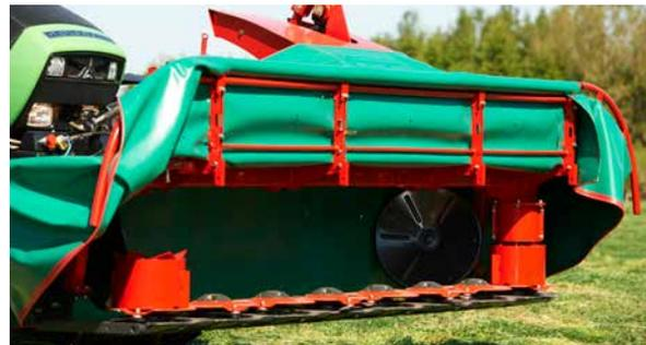
Fácil acceso a la barra de corte con protecciones delanteras y laterales plegables.
