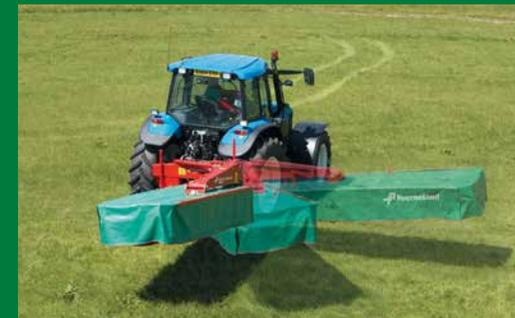
Para el transporte, la máquina se pliega horizontalmente directamente desde el puesto de mando. Rápido y fácil de hacer sin dejar el asiento del conductor.
