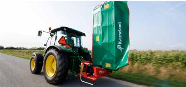
La posición de transporte se ajusta hidráulicamente desde el puesto de mando en posición vertical.
