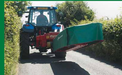
La Kverneland 2540 MH está bloqueada en posición horizontal para el transporte, ofreciendo una perfecta visión trasera para el transporte.
