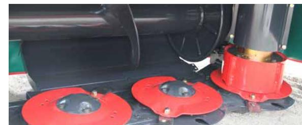
Dispositivo activo de hilado que produce hileras estructuradas.
