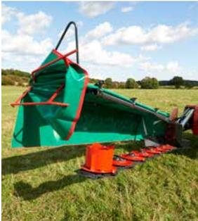
Fácil acceso a la barra de corte para la inspección y el mantenimiento.
